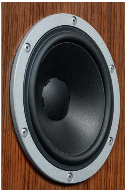
Cewka drgająca o średnicy 38 mm to solidna podstawa układu drgającego dla głośnika średniotonowego, ważna jest możliwość przyjęcia dużej porcji mocy, zwłaszcza przy niskiej częstotliwości podziału (tutaj w okolicach 300 Hz) i łagodnym filtrowaniu.
