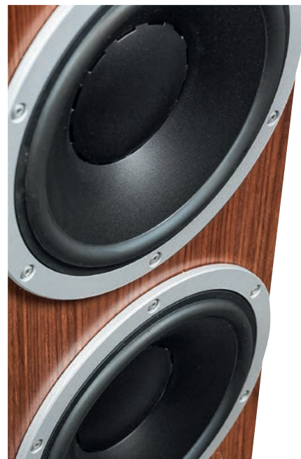
Głośniki niskotonowe mają cewki 75 mm, ich średnicę można zobaczyć z zewnątrz, ze względu na specjalny profil i technologię membrany – jest wytłaczana z jednego kawałka, a cewka jest dołączona na okręgu dzielącym profil membrany.
